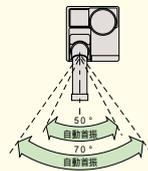
2つの吹出口が同時に、個別にオートスイング(SUASP2A) 2口を同時スイングすれば、本体周囲の全てに冷風が広がります。
